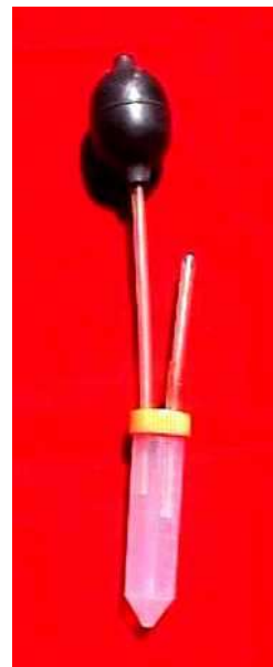
Fig. 1. Pulverizador usado para aplicar el polen sobre el medio de cultivo en el plato petri.
