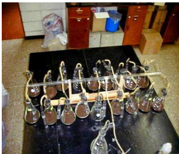
Fig. 1. Diagrama y fotografía del sistema de flujo de aire para limpiar y atrapar el \text{CO}_2 producto de la actividad microbiana en un compost
