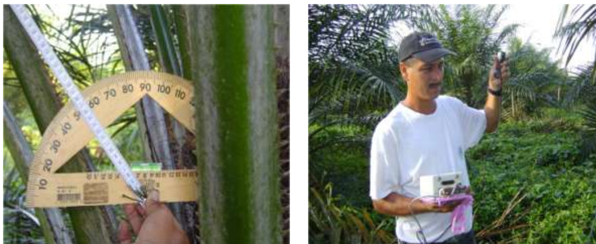
Fig. 2. Instrumentos usados para determinar la curvatura del raquis. Derecha. Medición de PARin no interceptada con un radiómetro
